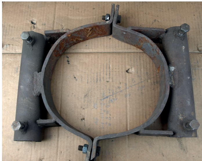
Obr. 2 – Svorka, která se připevnila k vrcholu věže. Do bočních trubic bylo možné zasunout lešenářské trubky a sestavit tak pracovní plošinu. Foto Jan Lehner.
